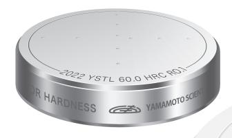
唯一の硬さ基準片専門メーカーである(株)山本科学工具研究社キャリブレーションセンターでは、世界的に高く評価されている JIS・ISO 準拠 高精度硬さ基準片をベースに、JCSS 校正事業者としての認定を取得、ISO/IEC 17025の基準を満たしたJCSS 硬さ基準片の製造及び販売を行っています。
